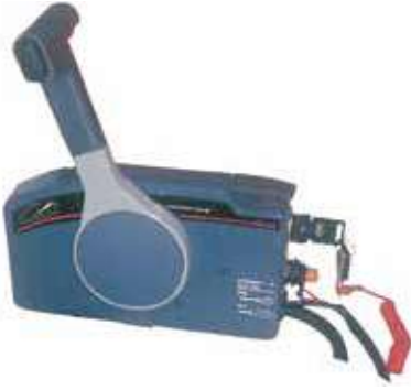
SR12052 Tekli Kol Yandan Montaj • Marşlı ve Trimli, 10 Pin'li • C 8 Tellere Uyumludur
