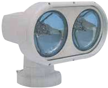
SR13124 Çiftli Kumandalı Projektör 12 V 2x55 W SR13125 Çiftli Kumandalı Projektör 24 V 2x55 W Boy: 220 En: 257 Derinlik: 210 mm Işık Gücü: 150 mt
