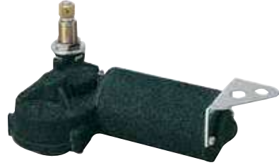
SR12230 TMC Silecek Motoru 12 V. SR12232 TMC Silecek Motoru 24 V. • Şaft: 51 mm • Silme Açısı: 110°
