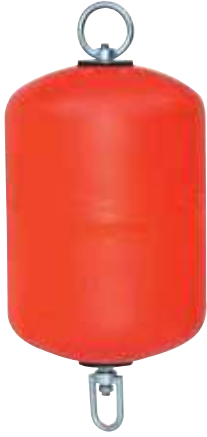
SR07876 Silindir Şamandıra 100 Litre Ağırlık: 11 kg Kaldırma: 90 kg Çap: 43 cm Boy: 65 cm SR07877 Silindir Şamandıra 200 Litre Ağırlık: 22 kg Kaldırma: 150 kg Çap: 64 cm Boy: 95 cm
