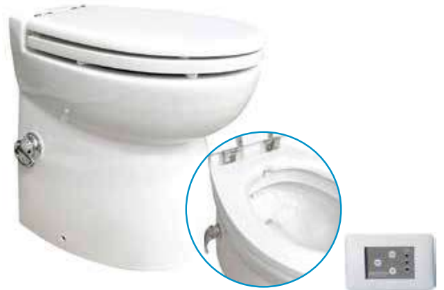
SR08526 Matromarine Vakumlu Tuvalet 12 V SR08528 Matromarine Vakumlu Tuvalet 24 V • Taharet Musluk Seti Tuvalete Dahildir. • En: 36 Boy: 46 Derinlik: 45 cm • Girişi: 26 mm, Çıkışı: 38 mm • Su Giriş İçin Harici Hidrofor Yada Selonoid Valf Kullanılmalıdır
